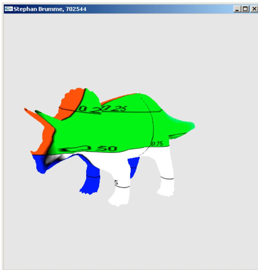
Gemäß der Bezeichnung *Two-Part-Mapping* erfolgt die Abbildung eines Oberflächenpunktes auf eine Textur-Koordinate in zwei Schritten: zuerst projiziere ich den Oberflächenpunkt auf das Zwischenobjekt, anschließend wird von diesem in die entsprechenden Texturkoordinaten umgerechnet.
