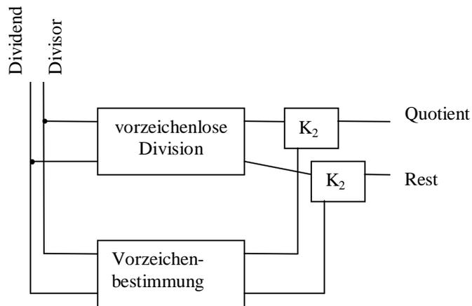
Die  $K_2$ -Einheiten sind als Multiplexer zu verstehen, die, wenn der Eingang, der der Vorzeichenbestimmung entstammt, 1 ist, das Zweierkomplement des anderen Eingangs, der ein Teil des Divisionsergebnisses ist, bilden.
